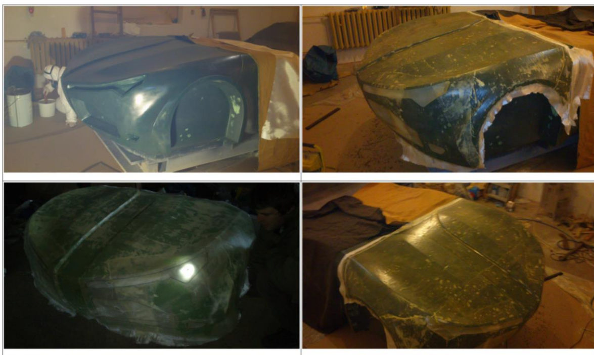
Rys. 20. Wytwarzania próbnego poszycia z kompozytu na bazie włókna szklanego.
