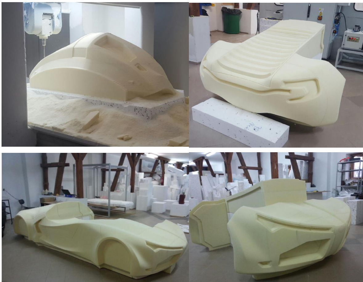
Rys. 18. Elementy kopyta wyfrezowane ze specjalnej pianki modelowej.
