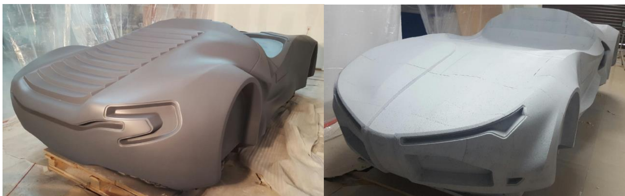
Rys. 19. Elementy kopyta podczas obróbki wykańczającej.
