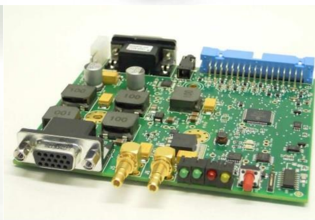
Rysunek 4. Laser impulsowy SNP-20F-100 wraz z kontrolerem Q-switch dedykowanym dla laserów impulsowych.
