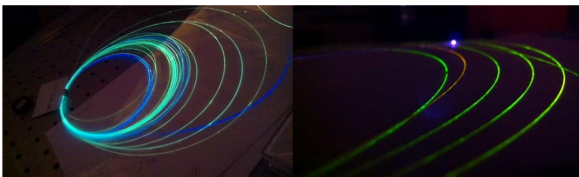
Rysunek 10. Rozproszenie barwne na włóknie o zaprojektowanej dyspersji
