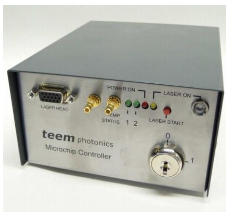
Rysunek 4. Laser impulsowy SNP-20F-100 wraz z kontrolerem Q-switch dedykowanym dla laserów impulsowych.
