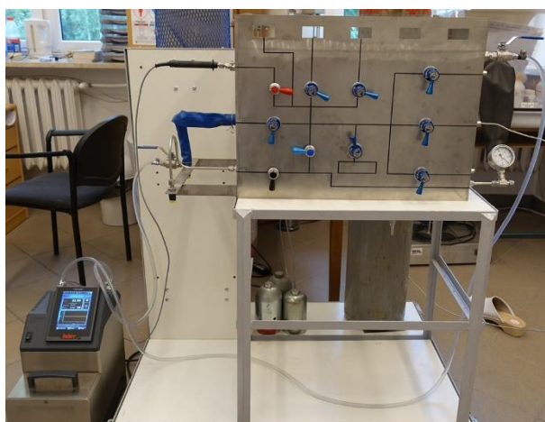
Fot. 31. Panel główny z pokrętkami zaworów i obiegowym schładzaczem podłączonym to układu. Wbudowany w termostat, zewnętrzny czujnik temperatury umożliwia precyzyjne sterowanie medium grzewczo/chłodzącym w zakresie od 0 do 80 °C, z dokładnością 0,01 °C.
