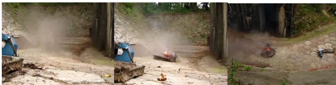
Rys. 20. Stopklatki wycięte po 0,3 s od momentu wystrzelenia proszku z lufy. W kolejności od lewej: ślepa próba, wystrzał tuż nad języki płomieni, strzał centralnie w centrum paleniska. W żadnym z przypadków nie zaobserwowano zapłonu rozpylanego materiału.
