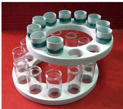
Rys. 2. Oprzyrządowanie do cylindra mielącego – holder: pierścień górny wraz z króćcami zasypowymi oraz pierścień dolny z osadzonymi w nim fiolkami na badany materiał.
