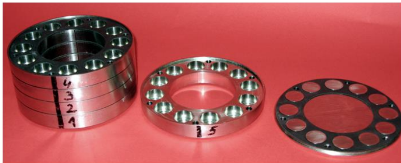
Rys. 1. Pięciosegmentowy cylinder mielący młynka do kombinatoryjnego wytwarzania bibliotek, od lewej: zestaw 4 segmentów, pojedynczy segment oraz wieczko cylindra wraz z uszczelką.
