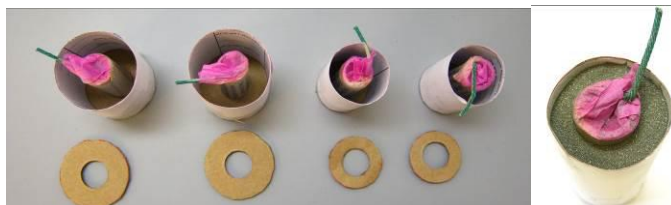
Rys. 13. Zdjęcie przedstawiające ładunki przed i po elaboracji.
