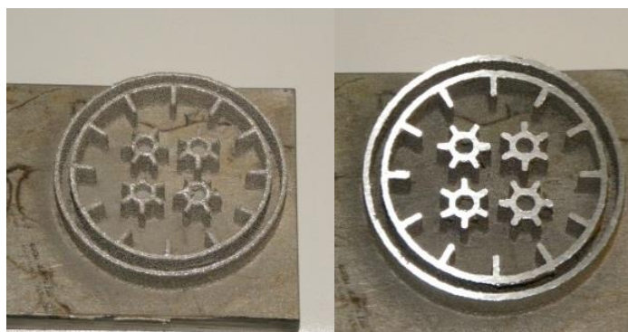
Rysunek 27 Fragment zbiornika z kanałami odprowadzającymi/doprowadzającymi ciepło
