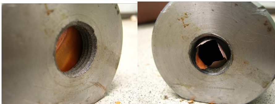
Rys. 18. Widok membrany przed (po lewej) i po przerwaniu, grubość wykorzystanej blachy Cu = 0,20 mm, ciśnienie przebicia = 120 bar.
