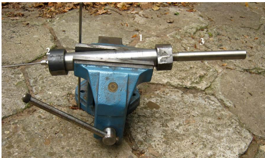
Rys. 17. Zdjęcie przedstawiające układ do gazowego rozpylania proszków.
