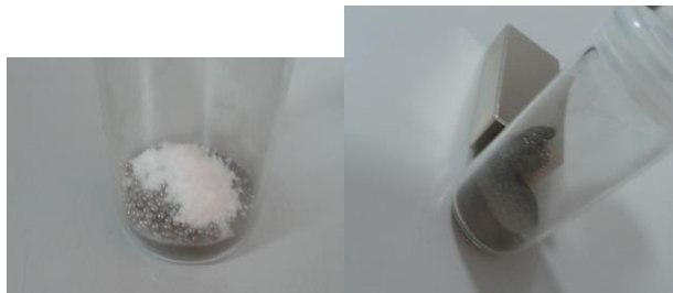
Rysunek 19. Fiolka z materiałem do mieszania przed (z lewej) i po procesie (z prawej).
