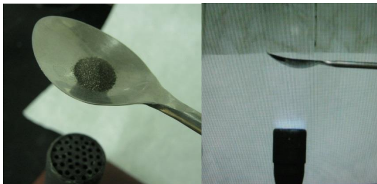
Rysunek 28 Proszek \text{LaNi}_5 podczas ogrzewania nad palnikiem Bunsena.
